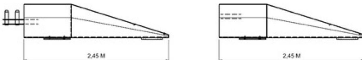
obr. 4 – náběhové díly – zástrčný / zasouvací dílec
